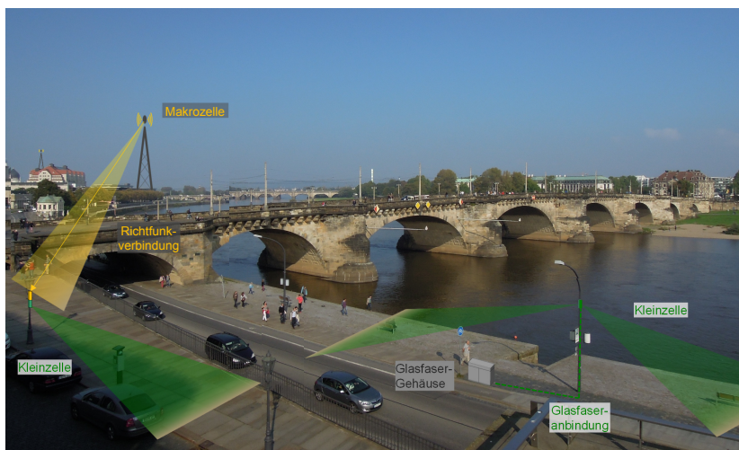
Darstellung der unterschiedlichen Anbindungsmöglichkeiten der Kleinzellen über Funk oder Glasfaser.
