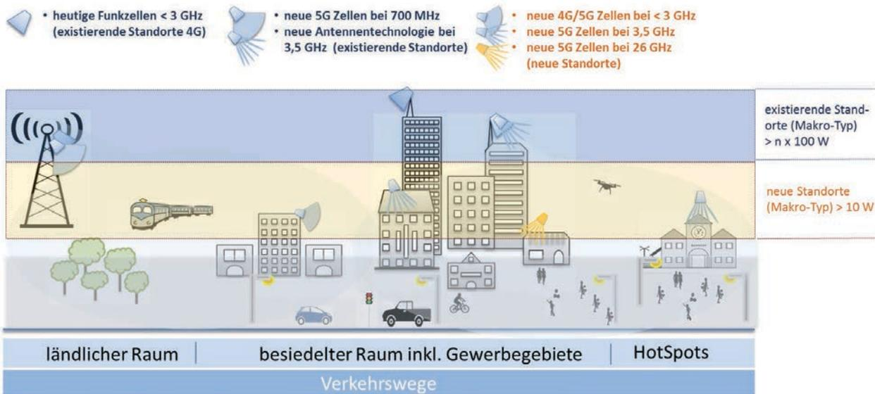
Abbildung 5: Schematische Darstellung zusätzlicher Makro-ähnlicher Standorte zur Verdichtung
