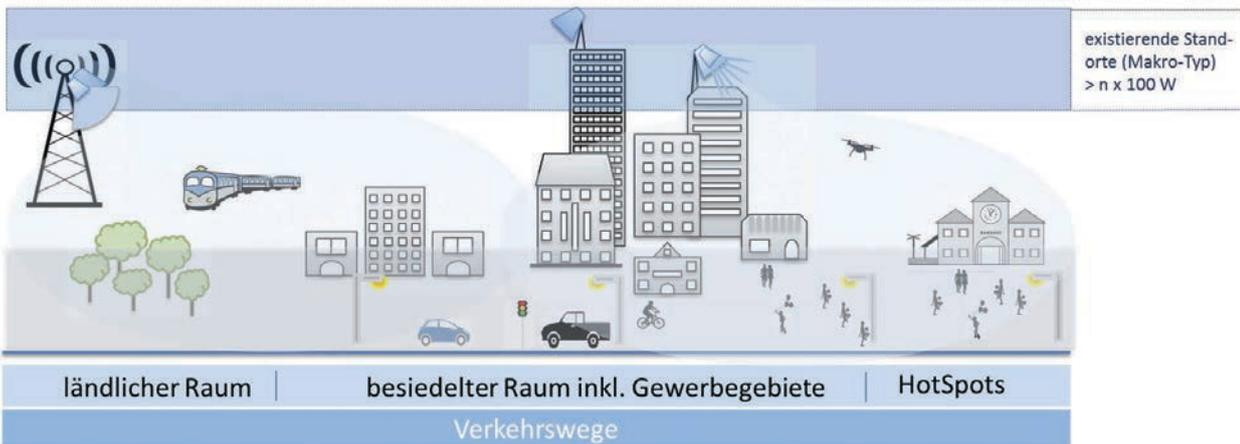
Abbildung 3: Schematische Darstellung einer ersten 5G Ausbaustufe auf existierenden Standorten
