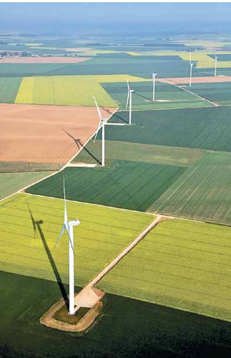
Abbildung 13: Schattenwurf von Windenergieanlagen (Quelle: Nordex SE)
