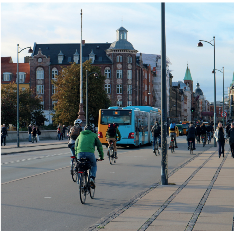
Baulich getrennter Radweg auf der Königin-Luise-Brücke, Kopenhagen. Quelle: Dirk Schmidt, via Qimby.
