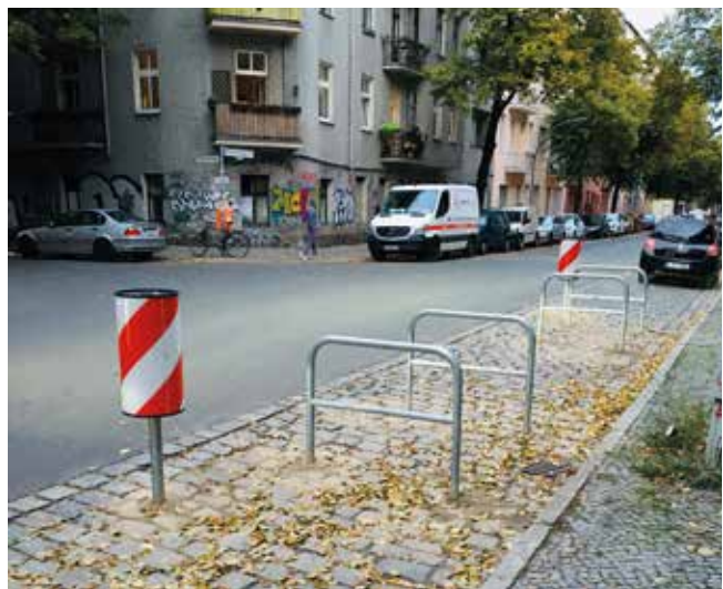
Fahrradbügel am Fahrbahnrand werden in Berlin-Neukölln eingesetzt, um Sichtbeziehungen zu verbessern und Verkehrsflächen neu zu verteilen. Quelle: ADFC
