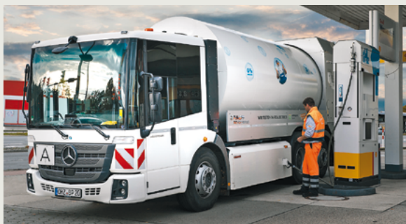
Getankt wird der Wasserstoff mit 700 bar in der herkömmlichen Geschwindigkeit
