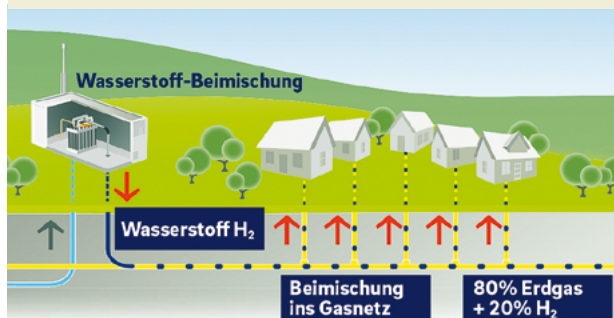
Beimischung von Wasserstoff in das Erdgasnetz
