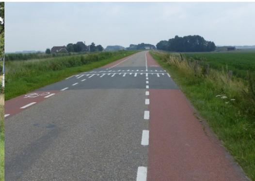
Bild 2-3: Aufpflasterung im Zuge einer Tempo 60-Landstraße mit Schutzstreifen (Foto: PGV-Alrutz)
