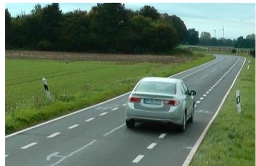
Bild 7-4: Kfz befährt den Schutzstreifen (BM2) = Regelung wird bei Alleinfahrt nicht akzeptiert (Foto: AB Stadtverkehr)
