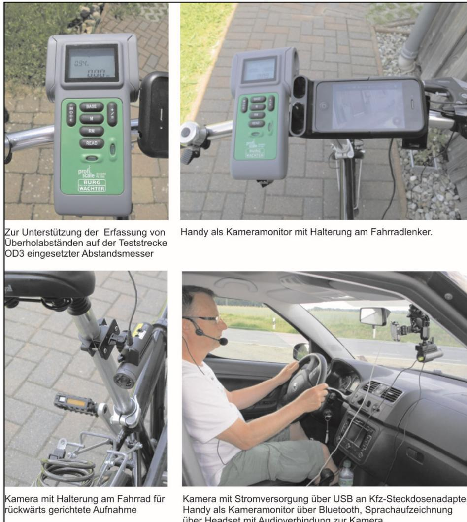
Zur Unterstützung der Erfassung von Überholabständen auf der Teststrecke OD3 eingesetzter Abstandsmesser
