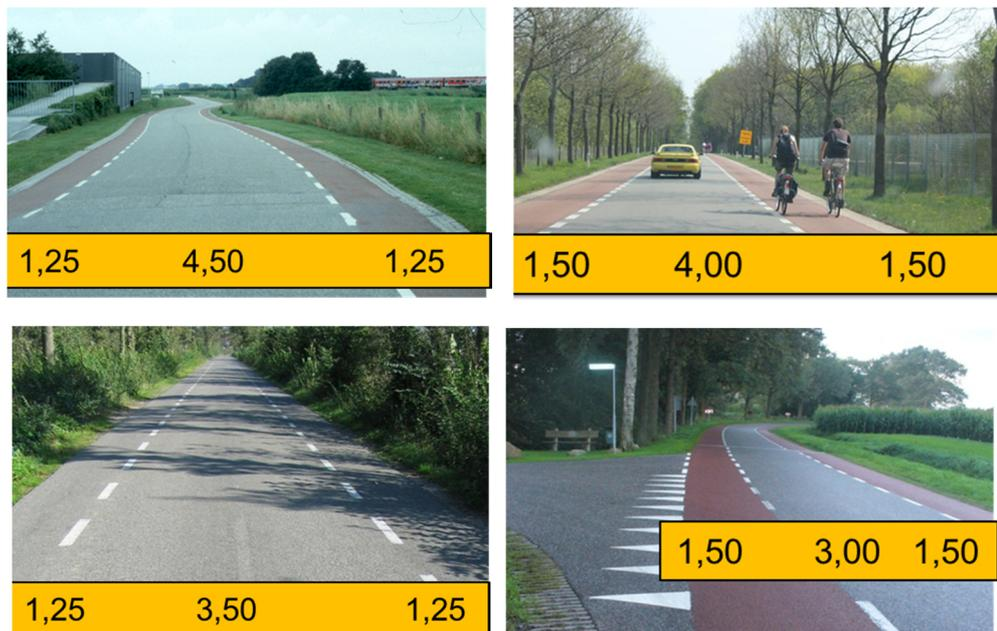
Bild 2-4: Unterschiedliche, in den Niederlanden vorzufindene Breiten von Schutzstreifen und Kernfahrbahnen
